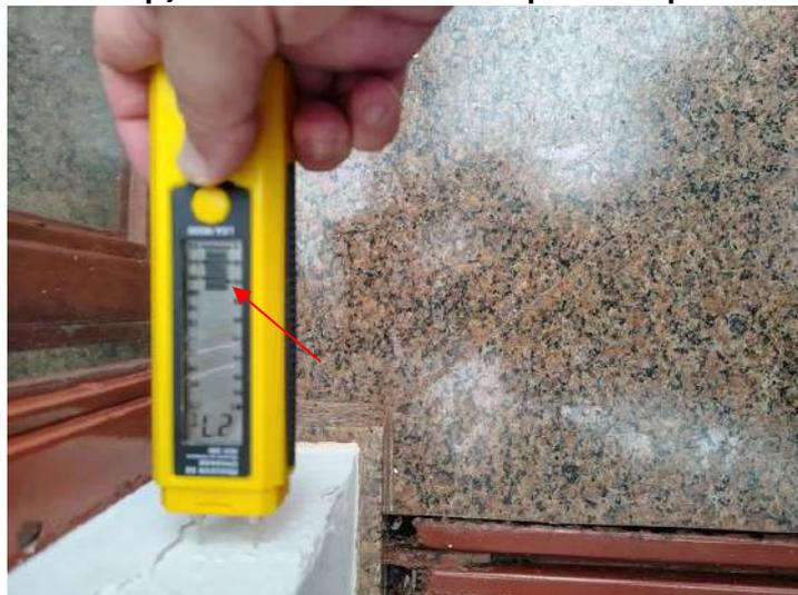
**FOTO 96 – Recepção – Umidade ao lado esquerdo da porta de entrada**
